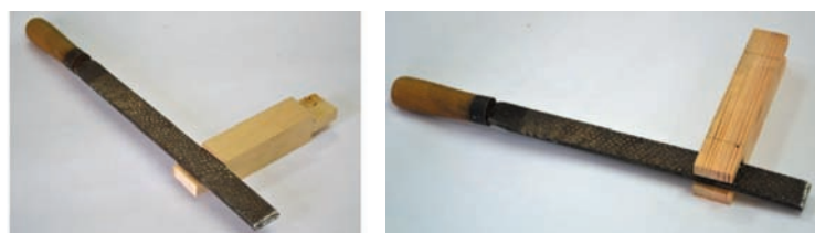
Рис. 71. Припасування вушка (гнізда) рашпілем
