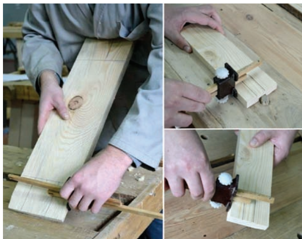
Рис. 66. Прийоми розмічання шипового з'єднання рейсмусом
