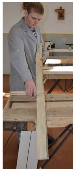
Рис. 44. Розмічання рейсмусом для стругання крайки
