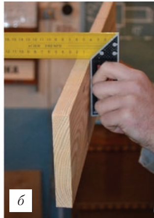
Рис. 60. Перевірка якості стругання: а – пласті; б – крайки
