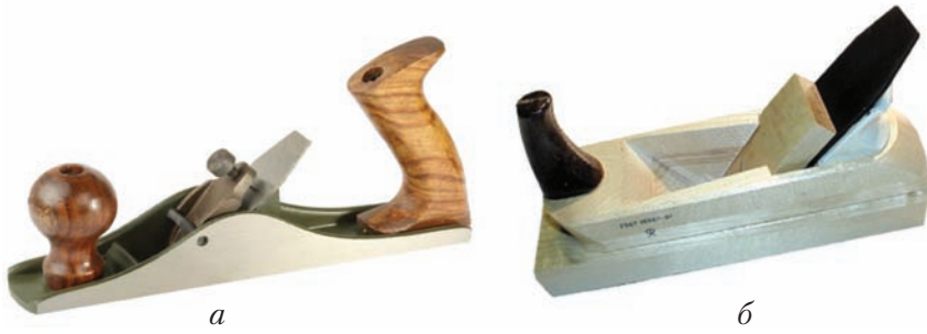
Рис. 52. Інструменти для стругання деревини: а – рубанок; б – шерхель
