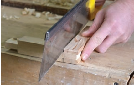
Рис. 72. Припасування шипового з'єднання ножівкою
