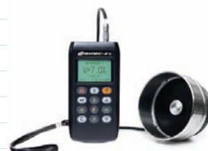
Рис. 17. Пристрої для вимірювання вологості деревини у промислових умовах
