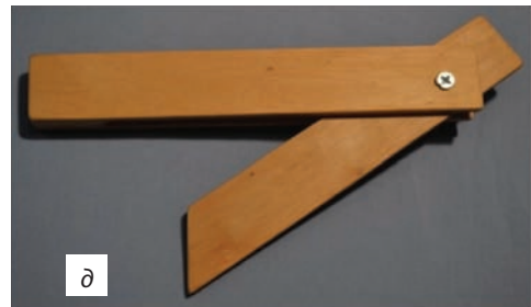
Рис. 38. Розмічальні інструменти: a – метр столярний; б – лінійка; в – кутник; г – ярунок; д – малка; е – рейсмус; є – циркуль
