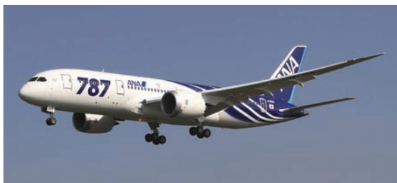
Рис. 3. Корпус новітнього пасажирського літака Boeing 787 Dreamline (перший політ – 2009 р.), що працює на відстанях понад 10 000 км, повністю виготовлений з композиційних матеріалів
