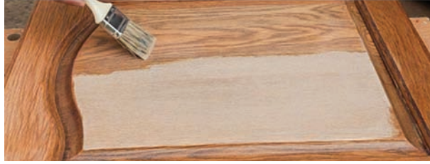
Рис. 77. Під час лакування з'являється малюнок текстури деревини
