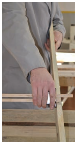
Рис. 43. Розмічання рейсмусом для стругання пласті
