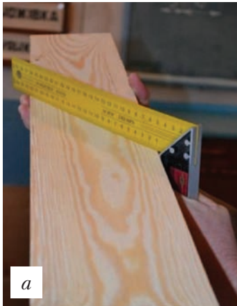
Рис. 60. Перевірка якості стругання: а – пласті; б – крайки
